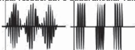
Figura I- Exemplo de modulações interferenciais: sinusoidal (esquerda) e quadrangular (direita).
